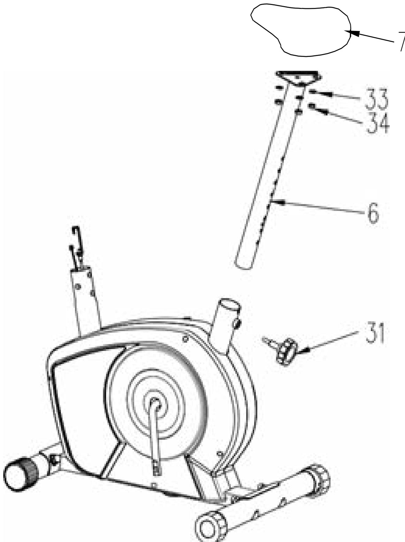
**ШАГ 3.** Закрепите сиденье (7) на подседельной стойке (6) шайбами (33) и гайками (34), вставьте стойку вместе с сиденьем в отверстие на раме (1) и зафиксируйте ручкой-фиксатором (31). **ВНИМАНИЕ!** Обратите внимание при выборе высоты сиденья на специальную ограничительную линию на подседельной стойке, которая не должна находиться выше края трубы на раме.
