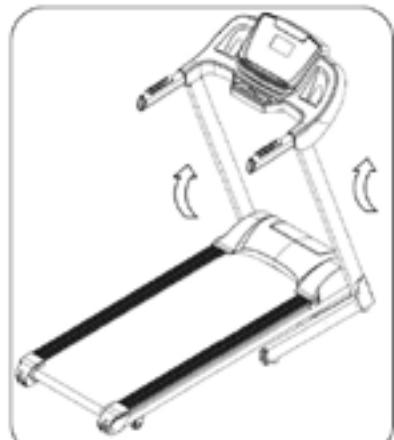
**Стадия 4.** С помощью шестигранника на 5 мм зафиксируйте сначала левую стойку (3) болтом M8\*45 (53) и шайбой (73), затем, болтом M8\*16 (51) и шайбой (64). Повторите то же самое с правой стойкой.
