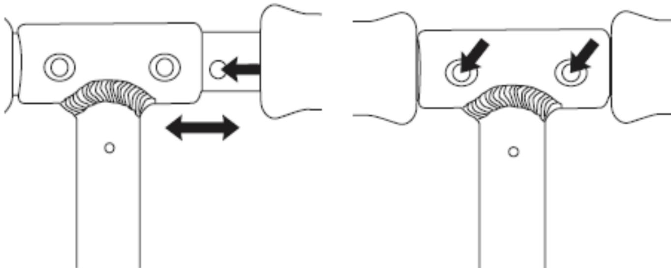
Для того, чтобы разложить самокат, ослабьте фиксатор на раме, отведите его в сторону и потяните за пластиковый эксцентрик. Почувствовав, что ход рулевой стойки стал свободнее, опустите деку до щелчка. Затем, немного затяните гайку рядом с фиксатором и заверните его по направлению к раме. Для того, чтобы сложить самокат повторите те же действия в обратном порядке.
