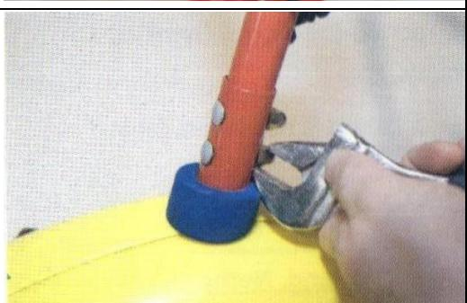
Установите ручку на раму. Закрепите с помощью двух болтов, гаек и шайб.
